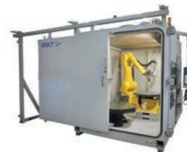
**ИЛИСТ-L+** – размеры выращиваемых изделий:  $\varnothing$  1500 мм, h – 1000 мм, масса – до 1000 кг.
