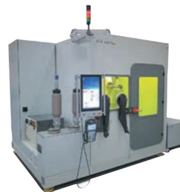
**ИЛИСТ-L** – базовая модель роботизированной установки прямого лазерного выращивания. Размеры выращиваемых изделий:  $\varnothing$  1300 мм, h – 800 мм, масса – до 400 кг.
