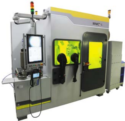
ИЛИСТ-L – базовая модель роботизированной установки прямого лазерного выращивания. Размеры выращиваемых изделий: Ø 1300 мм, h – 800 мм, масса – до 400 кг.
