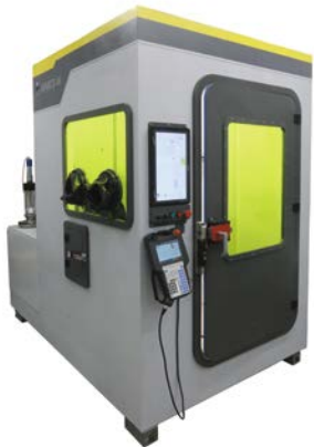
ИЛИСТ-M – размеры выращиваемых изделий: Ø 600 мм, h – 400 мм, масса – до 100 кг.
