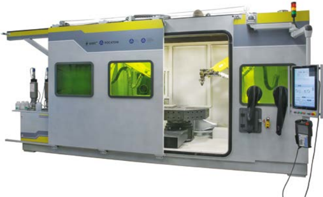
ИЛИСТ-2XL – размеры выращиваемых изделий: Ø 2200 мм, h – 1000 мм, масса – до 8000 кг.
