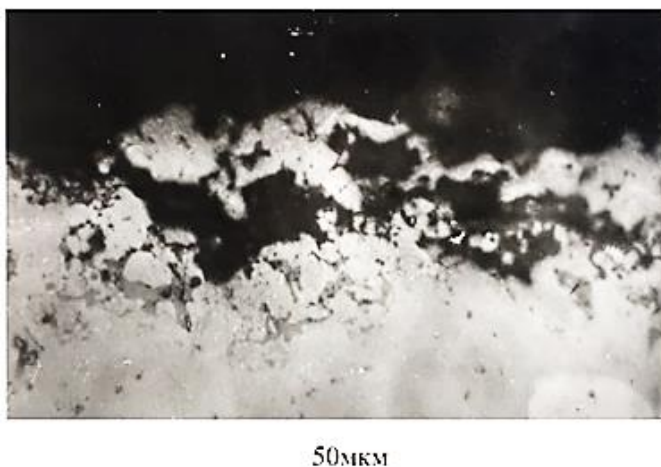
Рисунок 5 – Микроструктура сплава после испытаний при 900 °С
