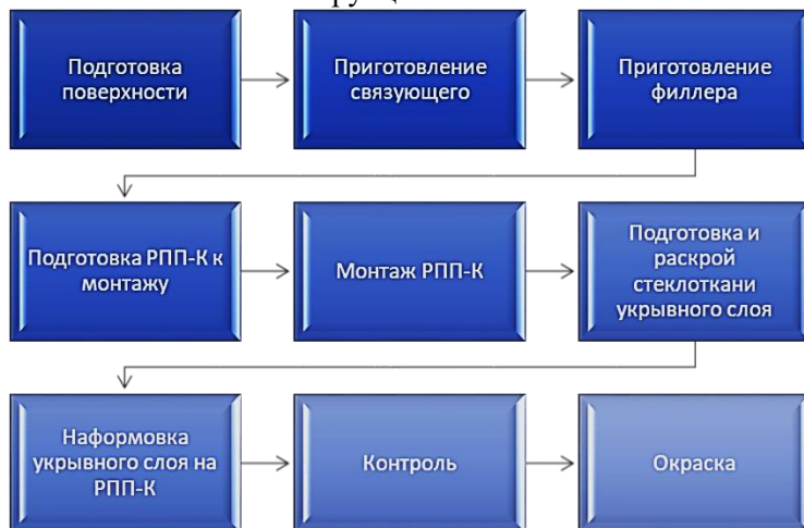
Рисунок 2 – Блок-схема технологического процесса монтажа РПП-К на конструкцию из ТС ПКМ
