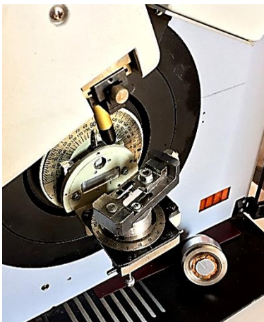
Рисунок 2 – Гониометрическая приставка, установленная на оси дифрактометра
