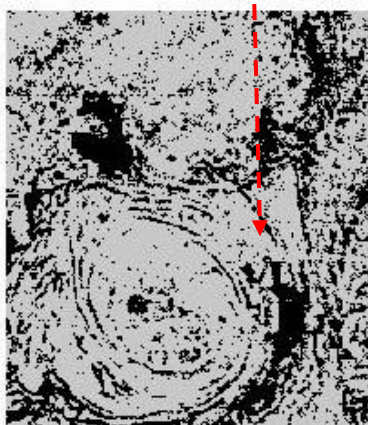
Рисунок 5 – Пример мультифрактальной аттестации структуры СЛП стали
