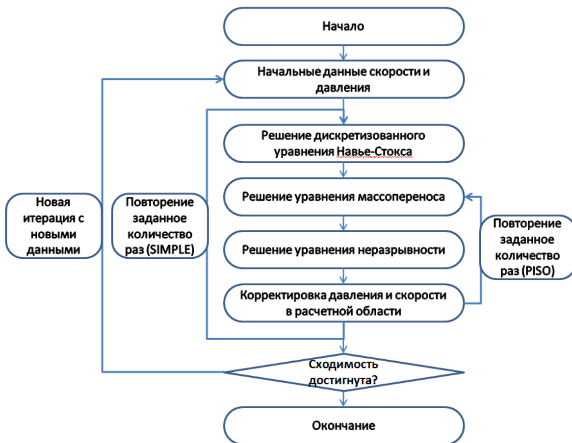
Рисунок 2.7 – Схема алгоритма PIMPLE
