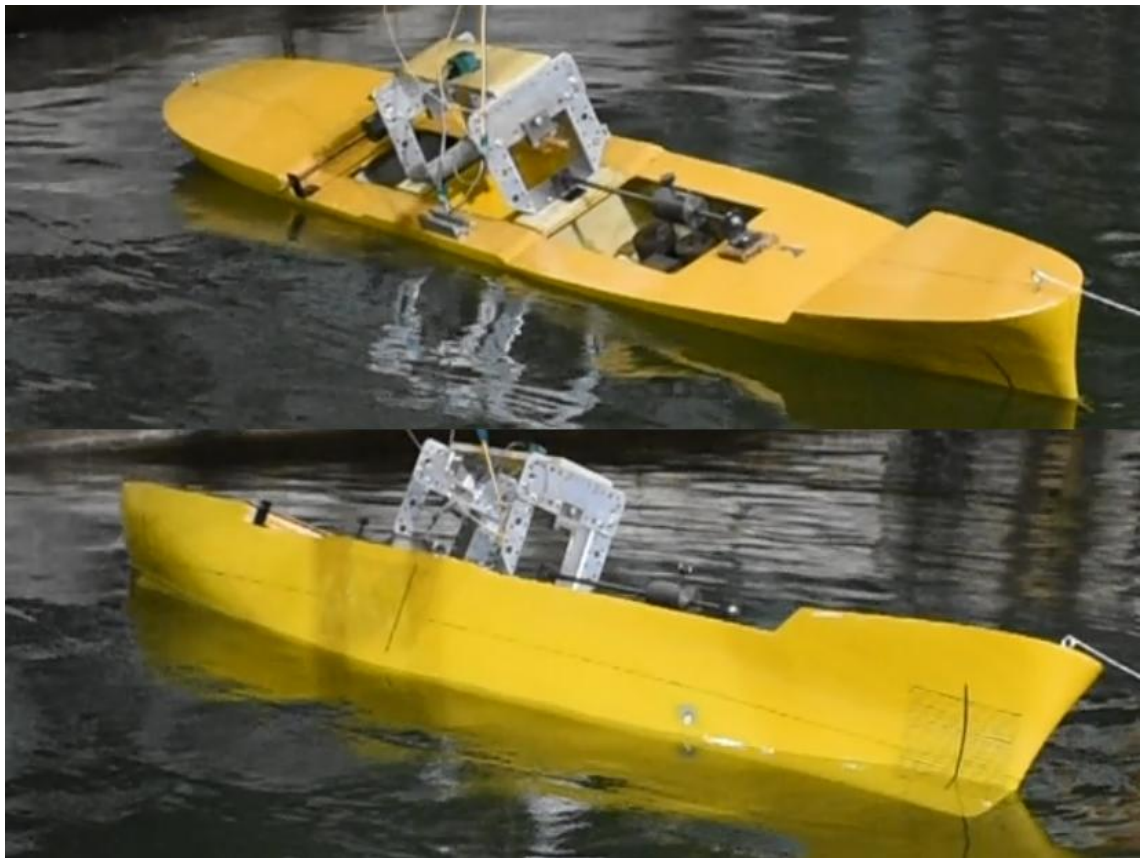
Рисунок 3.18 – Качка модели при лаговом волнении длиной 5,1 м
