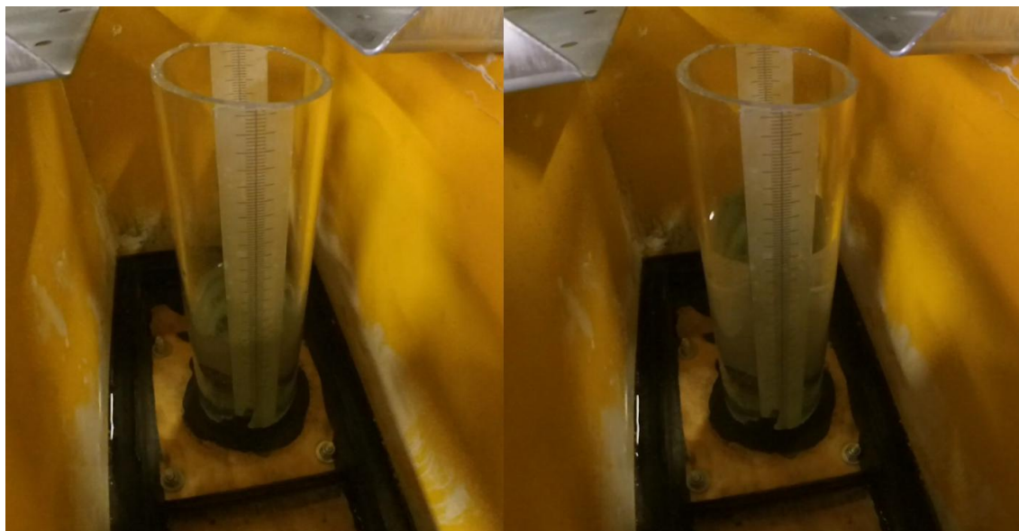
Рисунок 3.14 – Изменения уровня воды в шахте при качке модели на встречной волне длиной 4,0 м и высотой 0,079 м
