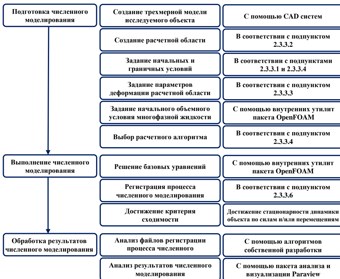
Рисунок 2.11 – Алгоритм выполнения численного моделирования динамики морских объектов в программном комплексе OpenFOAM
