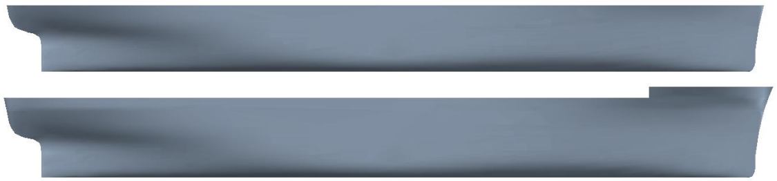
Рисунок 4.1 – Вид сбоку на трехмерные модели двух вариантов исполнения: сверху – с низким надводным бортом, снизу – с увеличенным надводным бортом и палубой бака
