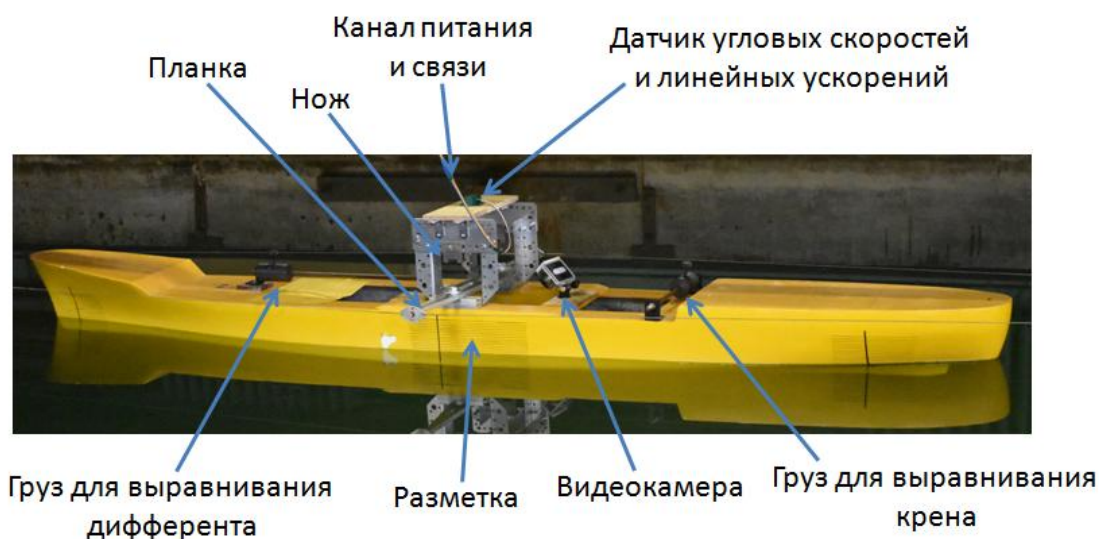
Рисунок 3.8 – Модель на плаву с установленными датчиками и приборами
