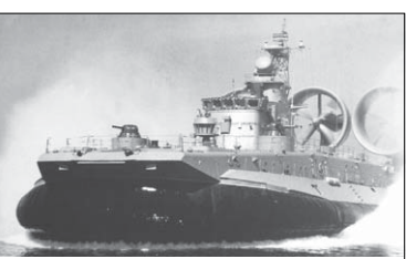
Малый десантный корабль на воздушной подушке «Зубр», проект 12322, главные конструкторы Ю.М. Мохов, Ю.П. Семенов, А.Н. Осинкин
