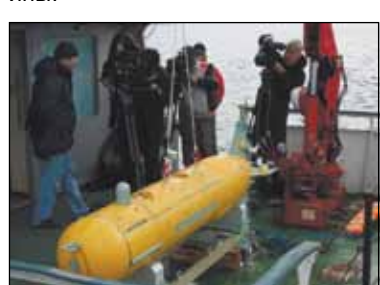
Автоматический подводный робот-разведчик «ПИЛИГРИМ» ИПМТ ДВО РАН
