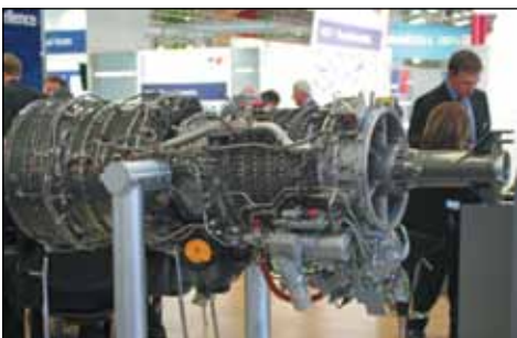
Новая компактная морская газовая турбина компании Rolls-Royce
