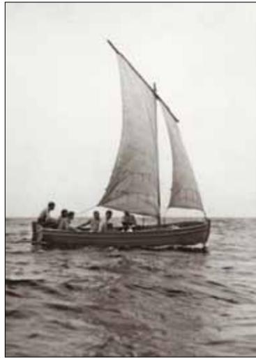
посреди залива. Затеяли измерение скорости своего хода. С носа бросаем щепку и засекаем время, когда с ней поравняется срез транца. Имея путь — длину корпуса шлюпки — 6 метров, и время, получаем скорость — что-то около 5 км/час. Вполне терпимая «весельная» скорость.
