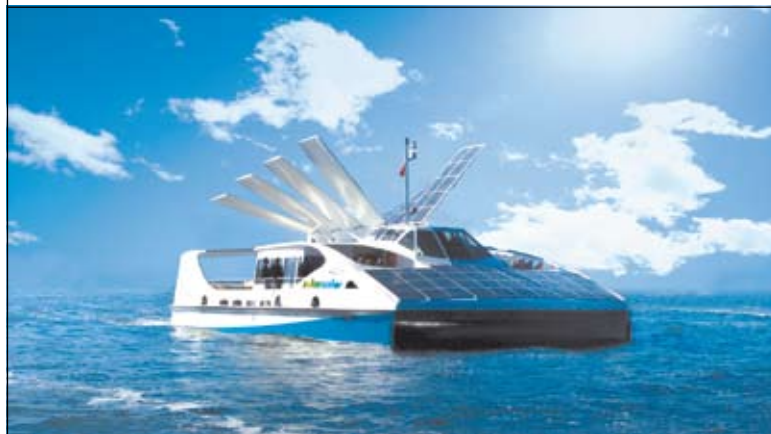
Проект танкера с тремя прочными 30-метровыми панелями — «солнечными» парусами австралийской компании «Solar Sailor». Компьютер должен самостоятельно выбирать такое положение панелей, чтобы получить максимальное количество солнечной энергии и сэкономить тем самым не менее 20–30% затрат на топливо. В пасмурную погоду используется обычный двигатель. Компания уже использует свои технологии в настоящее время на малотоннажных пассажирских судах.
