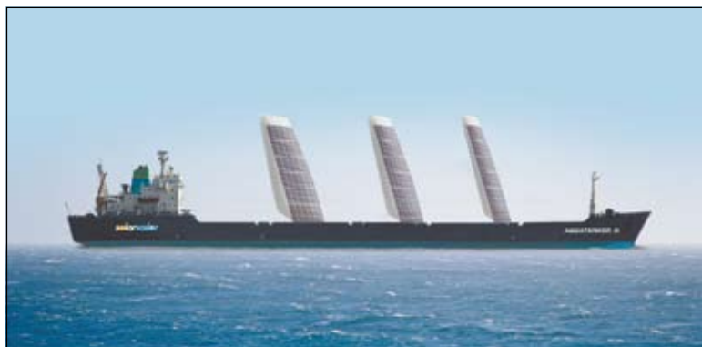
Проект танкера с тремя прочными 30-метровыми панелями — «солнечными» парусами австралийской компании «Solar Sailor». Компьютер должен самостоятельно выбирать такое положение панелей, чтобы получить максимальное количество солнечной энергии и сэкономить тем самым не менее 20–30% затрат на топливо. В пасмурную погоду используется обычный двигатель. Компания уже использует свои технологии в настоящее время на малотоннажных пассажирских судах.
