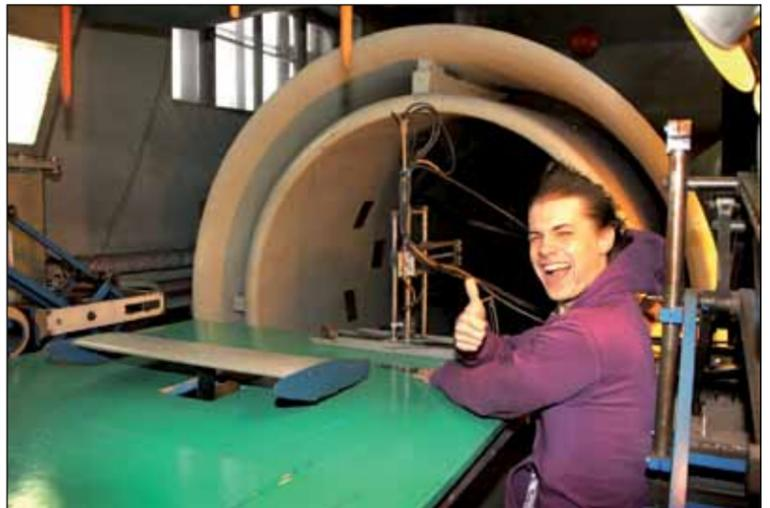
Студент специальности Гидроаэродинамика А. Шалада измеряет поле давлений во время продувки крыла в аэродинамической трубе кафедры Гидроаэромеханики и морской акустики. Фото В.Горшелева
