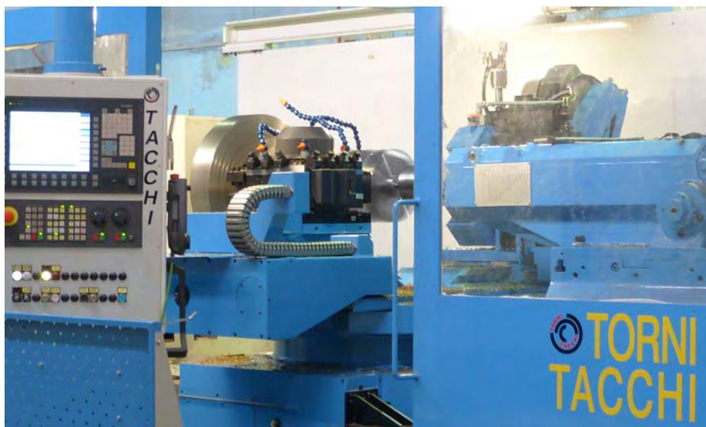
Рисунок 4.15 – Обработка сферической поверхности шарового запорного элемента на токарно-обрабатывающем станке VSF SERIES
