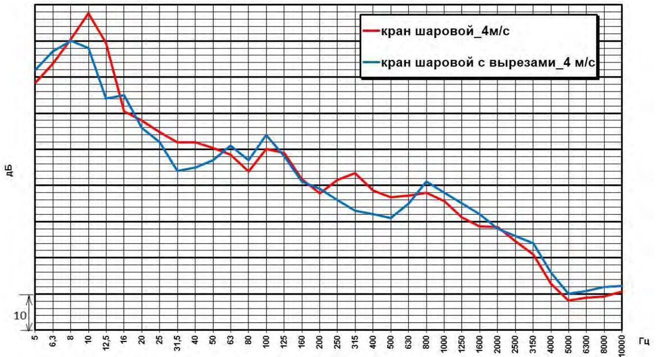
Рисунок 5.19 – Уровни ГДШ кранов шаровых (скорость проводимой среды 4 м/с)
