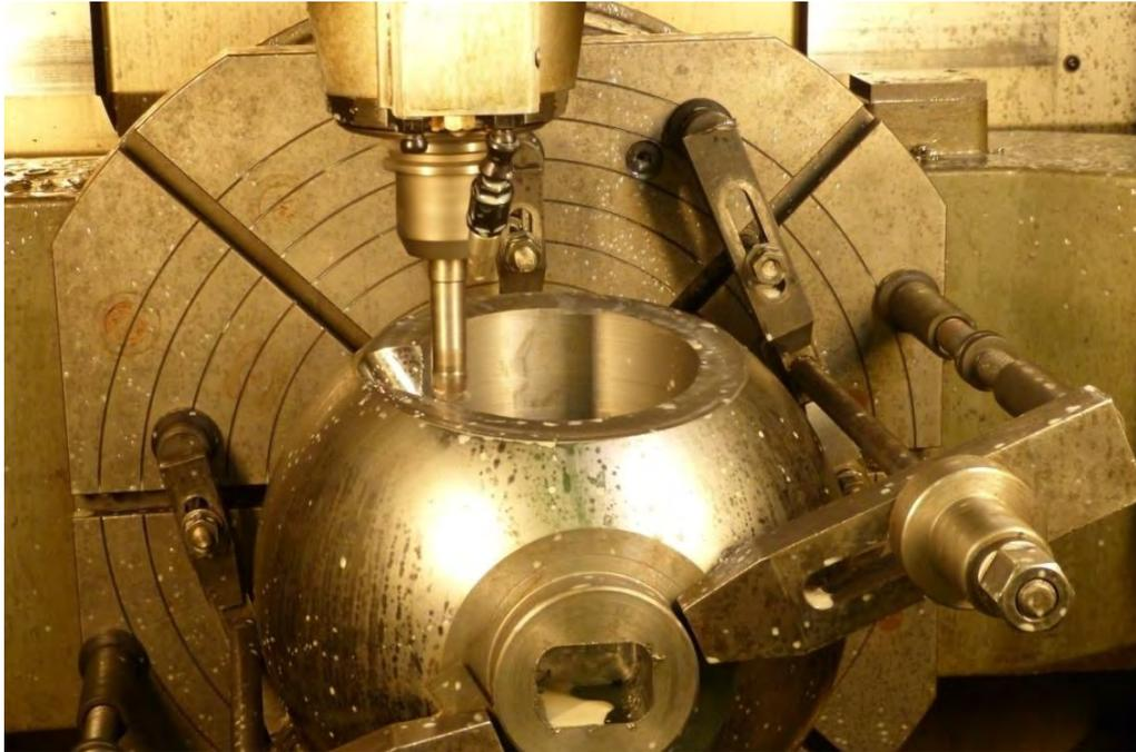
Рисунок 4.16 – Выполнение сегментного выреза на запорном элементе на фрезерном обрабатывающем центре HERMLE
