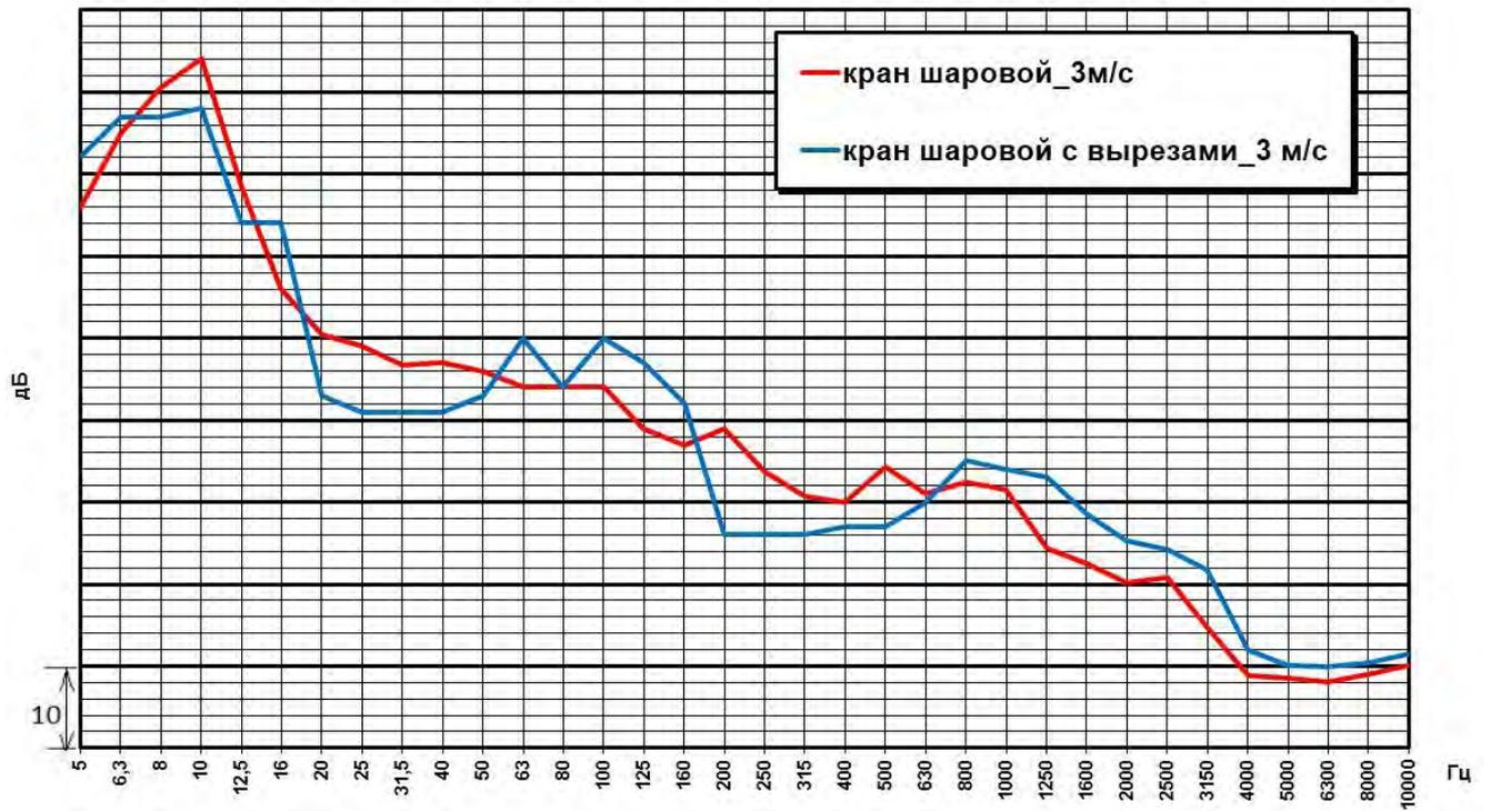
Рисунок 5.18 – Уровни ГДШ кранов шаровых (скорость проводимой среды 3 м/с)
